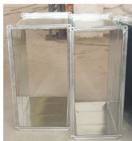
图21 风管外加固做法
